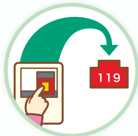
火災通報装置
